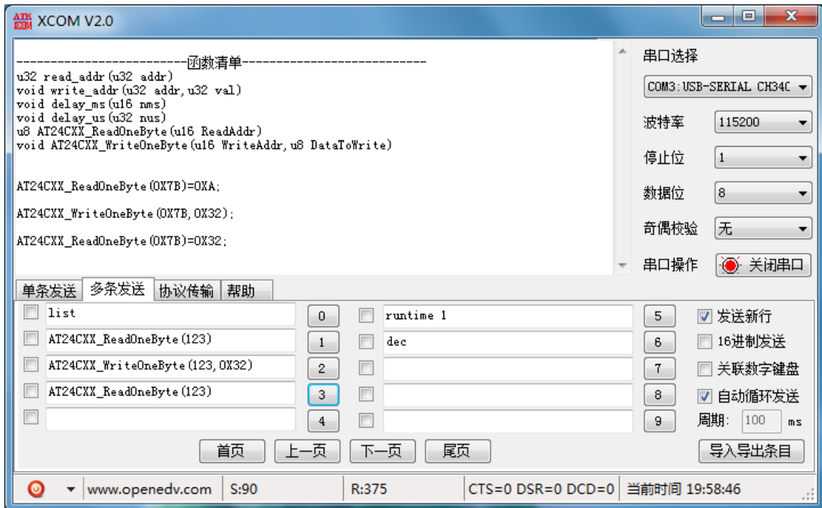
图 28.4.2 USART 控制 24C02 读写
