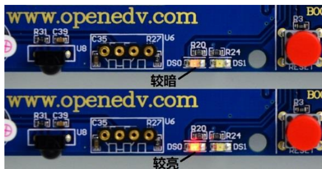
图 14.4.1 PWM 控制 DS0 亮度
